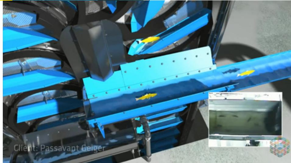
Bild 3: Kleine Fische werden aus dem Becher der Multidiscanlage in die Rückführung vorsichtig abgekippt. Start der Rückführung in die Fulda
